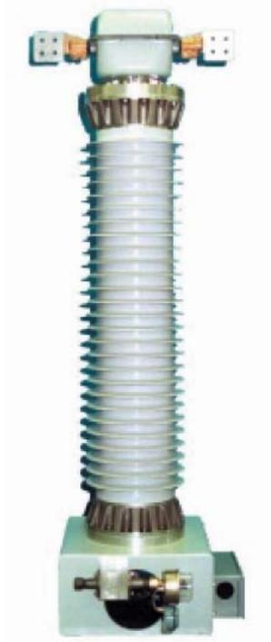
El elemento sensor óptico de corriente MOCT es montado en la parte superior del aislador de alta tensión en una caja de protección, mientras que el sensor óptico de tensión se encuentra alojado en un ambiente sellado relleno de SF6. Las conexiones entre los sensores MOCT y EOVT en el OMU y los módulos electrónicos en la sala control son vía fibra óptica.
